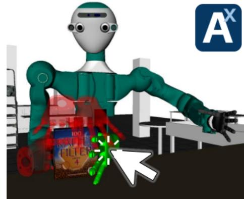
3D-Visualisierung von **ARMAR-6** beim Greifen eines Objekts in ArmarX.
