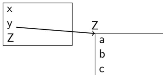
Bei Analyse von  $y.f(a)$  wird unmittelbar hinter dem Punkt die Z-Tabelle verwendet, die über den Eintrag von  $y$  erreichbar ist. Für die Parameterliste  $a$  wird wieder der Symboltabellen-Stack (Blockschachtelung) verwendet.
